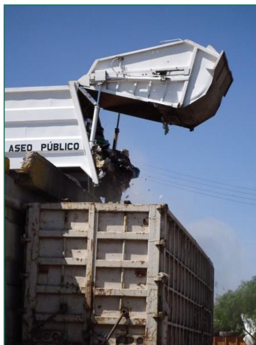
Figura 2-63 Descarga de residuos a las cajas de transferencia
